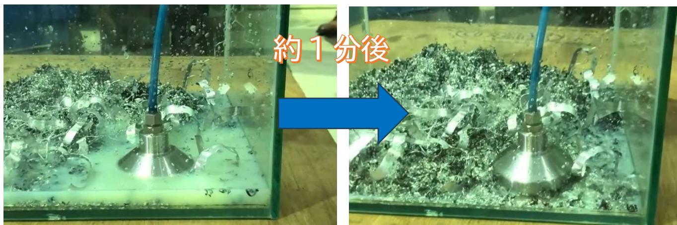
クーラント回収の様子(クーラントセーバーにて実施)
