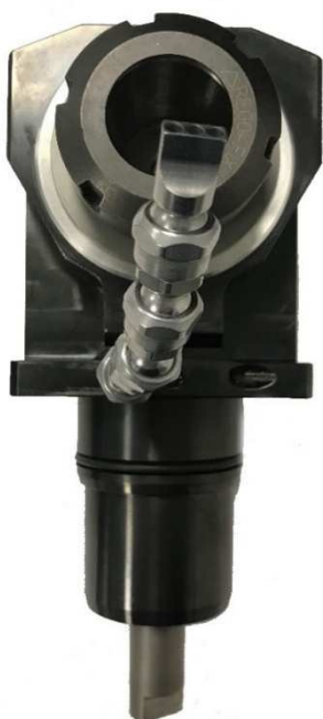
ロータリーツールホルダーに取り付けた HECTO システム ストレートノズル ID:3mm & L:20mm
