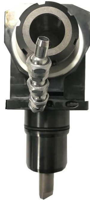
ロータリーツールホルダーに取り付けた HECTO システム ストレートノズル ID:6mm & L:16mm
